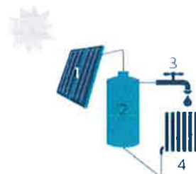
1 Zonnecollector | 2 Opslagvat 3 Sanitair warm water 4 Radiator
